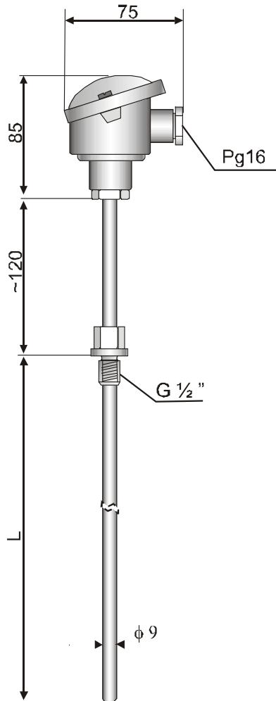
➤ TTS - 09 A je temperaturna sonda sa glavom, pripada
